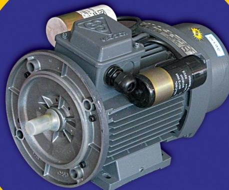
الکتروموتورهای تک فاز صنعتی خازن دائم - خازن استارت (CRS)، تک دور با فریم آلومینیومی، مطابق با استانداردهای IEC، روتور قفس سنجابی، درجه حفاظت IP44 مناسب برای کار دائم، روش تهویه IC411 با پروانه خنک کننده و پره‌های روتور، کلاس حرارتی F، فرکانس کار 50HZ و ولتاژ نامی 220V (1)
